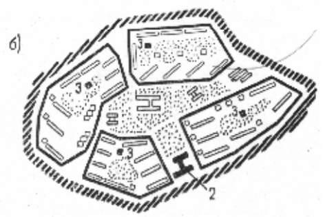
Рис. 285. Пример размещения культурно-бытового обслуживания (население каждого микрорайона 8 тыс. человек) a — схема района; б — схема микрорайона; 1 — торговый и общественный центр района с радиусом обслуживания 1400 м; 2 — торговый и общественный центр микрорайона с радиусом обслуживания 400—450 м; 3 — блок первичного обслуживания для группы домов с населением в 2000 человек с радиусом обслуживания 200 м
