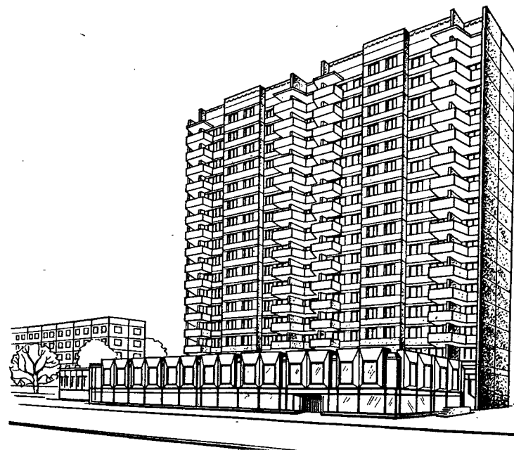
Рис. 1.16. Разрезы (а) и перспективы (б) встроенных и встроенно-пристроенных (внизу) нежилых помещений в первых этажах жилых домов серии П44 и П3
