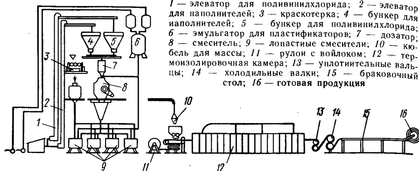
Рис. 15.2. Технологическая схема производства линолеума промазным способом:
