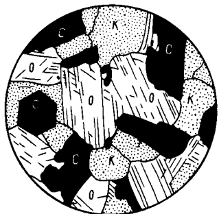
Рис. 2.1. Вид под микроскопом крупнокристаллической зернистой структуры гранита:
