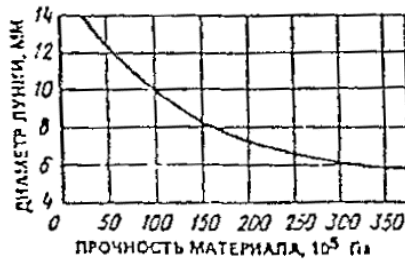
Рис. 6.8. Тарировочный график для определения предела прочности бетона при сжатии молотком Физделя
